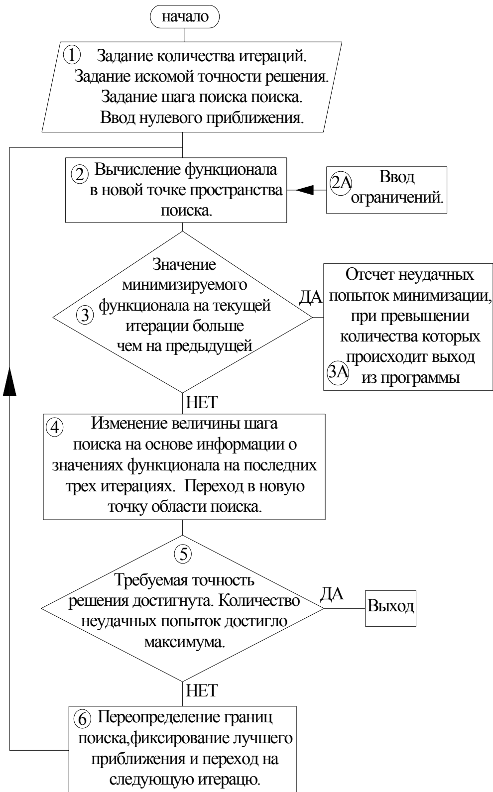
Рис. А1. Блок-схема алгоритма определения коэффициентов и степеней уравнения состояния методом случайного поиска с возвратом при неудачном шаге.
